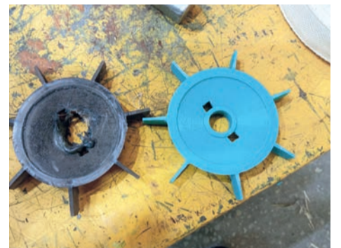
Крыльчатка обдува электродвигателя. Было – стало.
